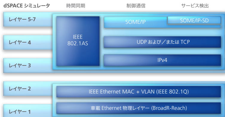
Ethernet を介したサービスベース通信の ISO/OSI レイヤーモデル
